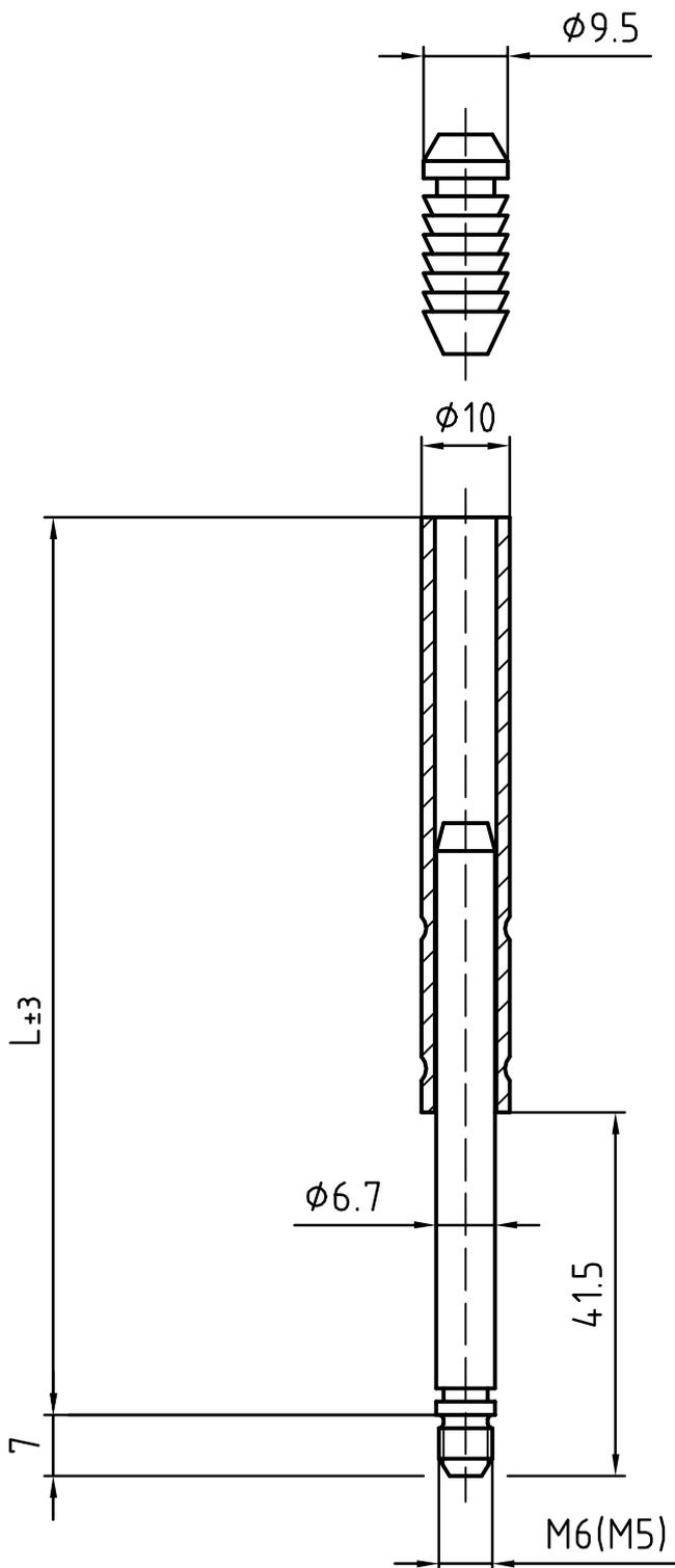
Der Gleitstopfen ist der Treibriegelstange nur lose beigelegt und wird nach dem Kürzen der Treibriegelstange in das obere Stangenende eingedrückt.
