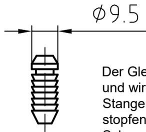
Der Gleitstopfen ist der Treibriegelstange nur lose beigelegt und wird nach dem Kürzen der Treibriegelstange in das obere Stangenende eingedrückt. (Eine Verwendung des Gleitstopfens ist nicht vorgeschrieben bzw. bei Verwendung eines Schnappriegels nicht möglich.)
